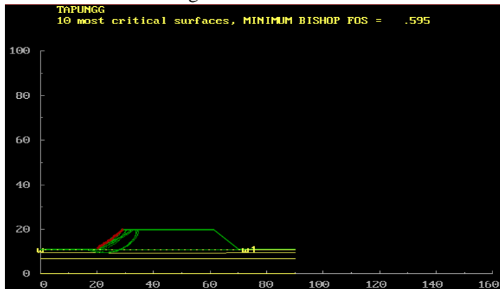
Gambar 5.30 Kestabilan timbunan pada 9 minggu preloading (Oprit Miring Zoning A-A)
