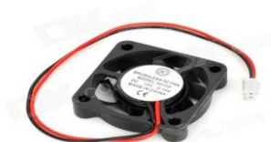
Gambar 2.8 bentuk fisik kipas DC.
