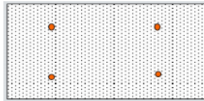
Gambar 4. 10 Skema Pengangkatan Pelat Lantai
