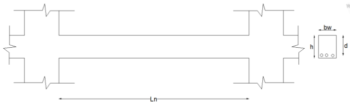
Gambar 2. 1 Penampang Balok Sumber : Gambar 9.8 (Imran. 2014)
