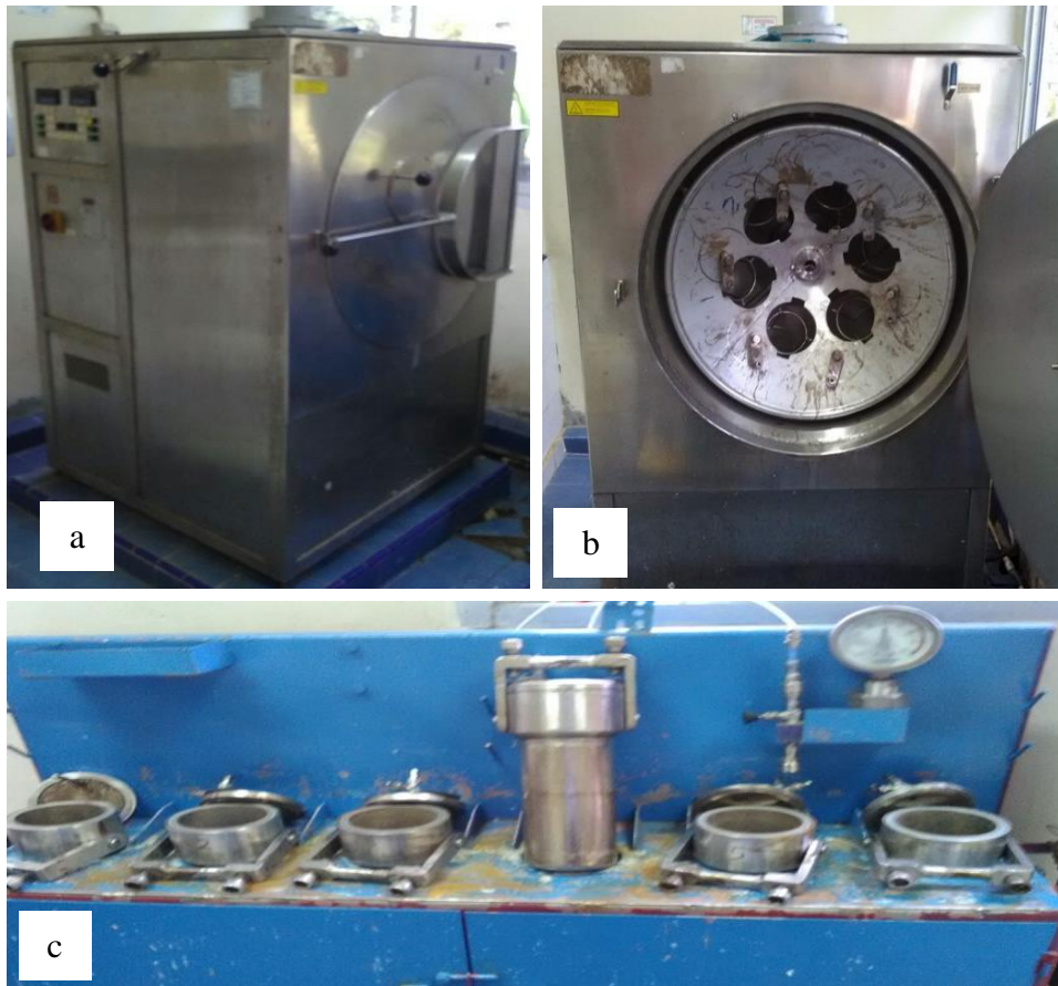
Gambar 3.2. Digester Haato dengan 6 tabung ( chambers ), (a) Digester tampak samping, (b) Digester tampak depan, (c) Tabung yang digunakan sebagai tempat sampel selama proses cooking .
