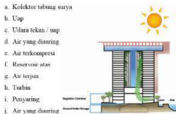
Gambar 2.16. Diagram Aliran Air Hujan pada Bangunan pada Musim Kemarau (Sumber: Penulis, 2017)
