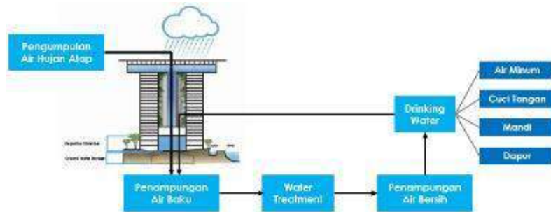
Gambar 2.5 Diagram Daur Ulang Air Drinking Water pada Apartemen (Sumber : Penulis 2017)
