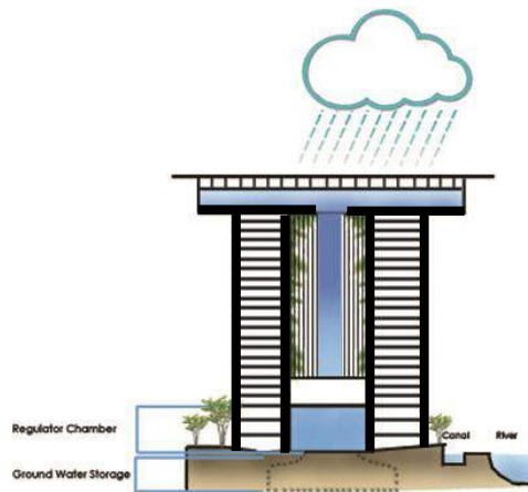
Gambar 2.3 Diagram Daur Ulang air pada apartemen dengan Curah Hujan Tinggi
