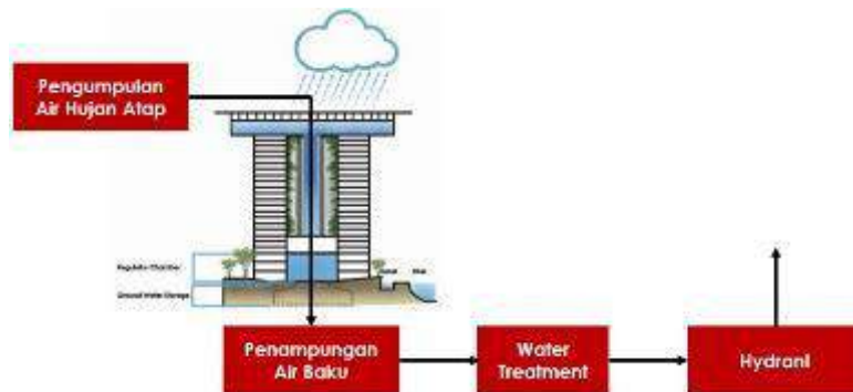
Gambar 2.7 Diagram Daur Ulang Air selain Hydrant pada Apartemen (Sumber : Penulis 2017)
