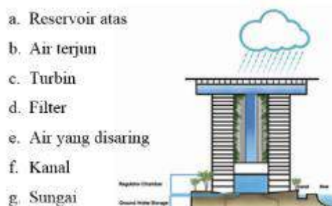
Gambar 2.17. Diagram Aliran Air Hujan pada Bangunan pada Musim Hujan (Sumber: Penulis, 2017)
