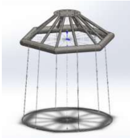
Gambar 4.3 Model Struktur FarmOcean tipe Solid dalam SolidWorks
