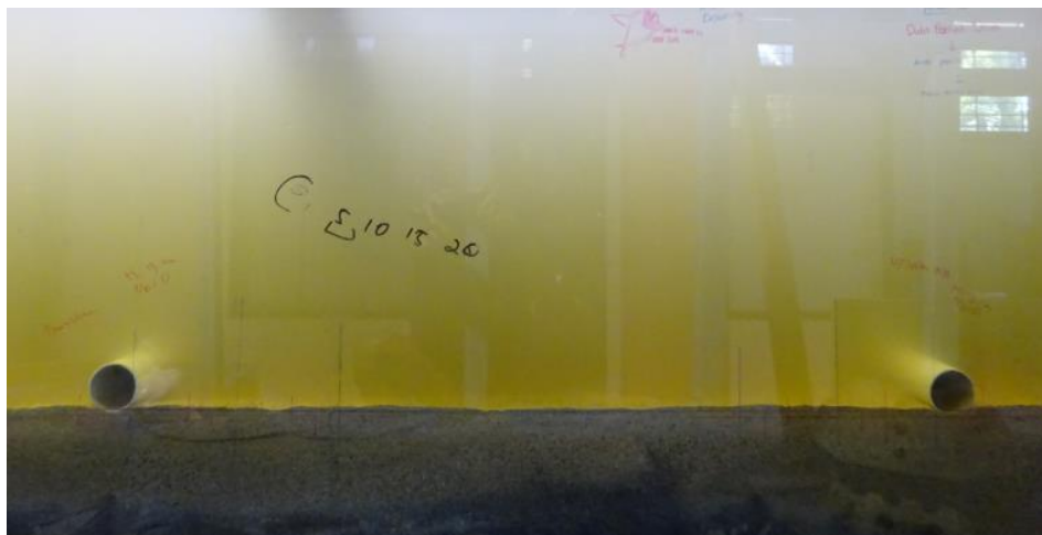
Gambar 4.61. Kondisi dua pipa in-trench jarak 80 cm
