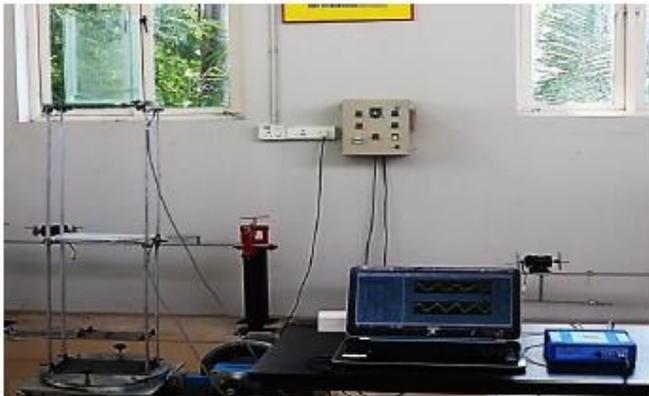
Gambar 2. 11 Rangkaian alat eskperimen model struktur dengan TLD [14]
