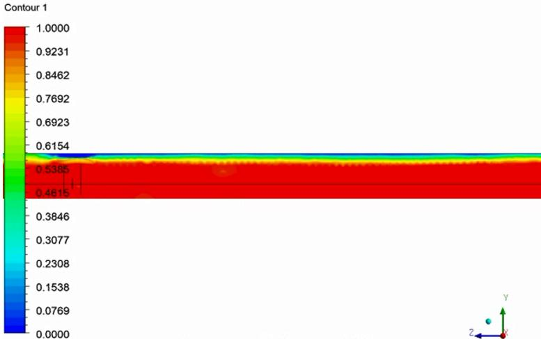
**Gambar 4. 9** Volume fraksi kanal larona 24 setelah diberi turbin sisi tengah
