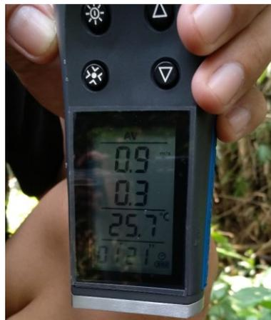
Gambar 3.3 JDC Flowatch untuk *Flow Meter*
