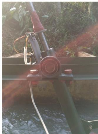
Gambar 4.6 Pengujian Konfigurasi dengan Kemiringan tetap  $30^\circ$
