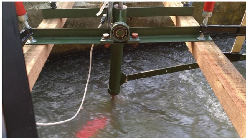
Gambar 4.1 Pengujian konfigurasi turbin  $0^\circ$ .
