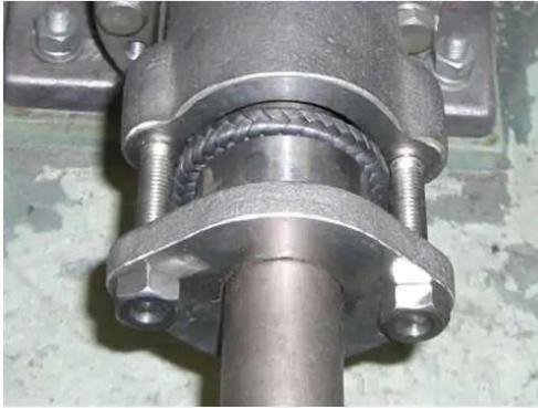
**Gambar 4.8** Jenis *Packing Gland* yang Digunakan pada *Sulphur Filter* FIL-1001A/B (The Rubber Company)
