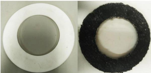
**Gambar 4.4** Gasket yang Digunakan pada *Sulphur Filter FIL-1001A/B* dengan Material PTFE (kiri) dan *Asbestos* (kanan)
