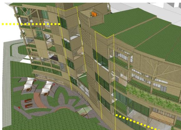
Gambar 27: Letak tangga darurat pada fasad 2
