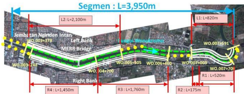
Gambar 4.16 Normalisasi Kali Jagir untuk perbaikan tanggul dan menambah kapasitas tampungan air Sumber : Dinas PU Bina Marga dan Pemsatuan, 2013
