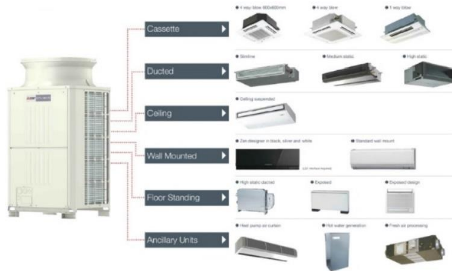
Gambar 4.21 Diagram Sistem Penghawaan AC Multisplit (sumber: images.google.com, 2018)
