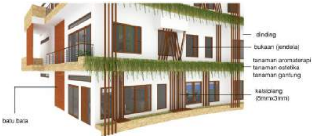
Gambar 5.19 Detail Selubung Bangunan
