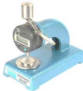
Gambar 3.6 Alat pengukur ketebalan
