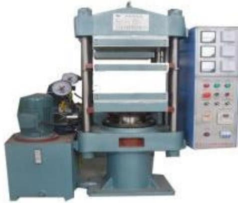
Gambar 3.3 Mesin *hot press*
