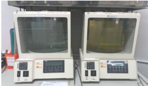
Gambar 3.6 Viskometer
