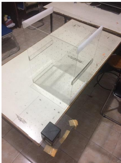
Gambar 3. 2 ruang kalibrasi dengan magnetic source
