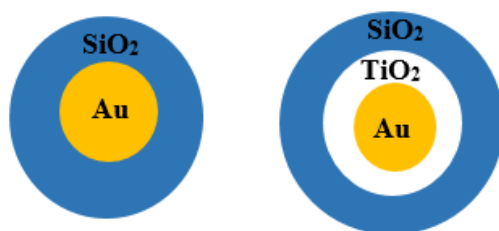
Gambar 3. 2 Skema nanopartikel struktur core-shell Au @SiO_2 dan Au@TiO_2@SiO_2
