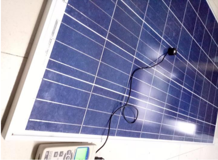
Gambar 1 Pengambilan data irradiansi matahari
