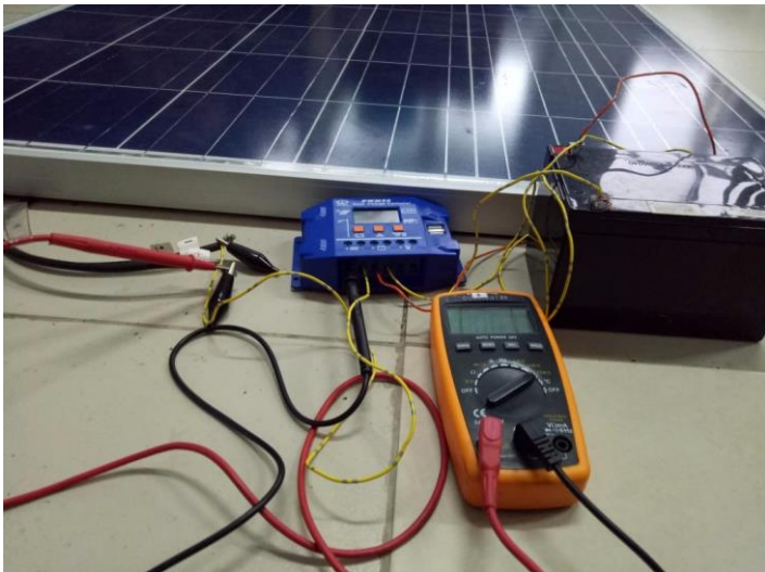
Gambar 2 Pengambilan data tegangan dan arus PV
