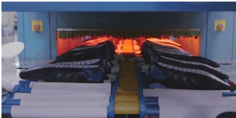
**Gambar 2.6** *Lasted Upper* yang berada pada *chamber*
