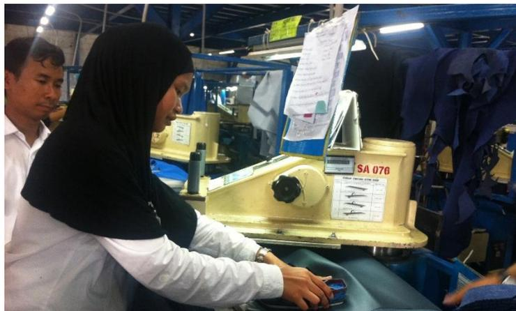
**Gambar 2.3** Proses pemotongan material dengan mesin *swing arm*
