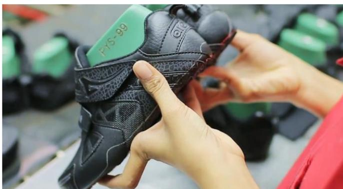
**Gambar 2.5** Sepatu setelah proses *lasting*
