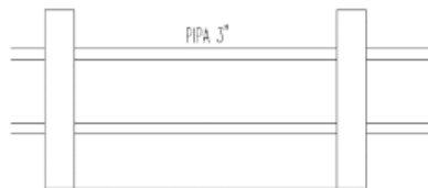
Gambar 2.12 Mekanisme Pembebanan dan Asumsi Struktur Akibat Beban Vertikal pada Pipa
