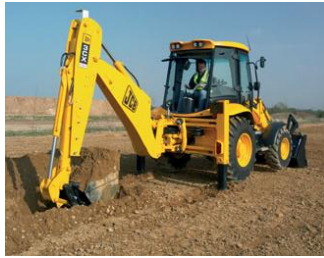
Gambar 4.14 : Contoh penggalian tanah pondasi dengan eskavator
