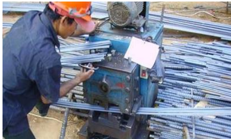
Gambar 4.60 : Contoh pemotongan besi tulangan
