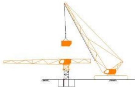
Gambar 4.24 : Pemasangan boom dan counter jib
