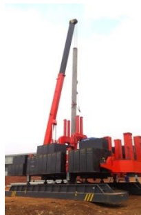
Gambar 4.13 : Contoh proses pemancangan dengan HSPD (Hydraulic Static Pile Driver)
