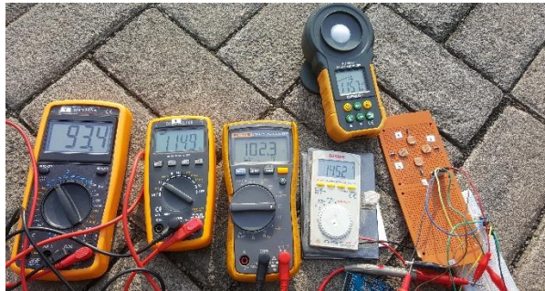
Gambar A. 12. Pengambilan Data Sensor LDR
