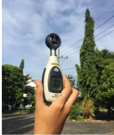
Gambar 3. 7. Pengambilan Data Kecepatan Angin
