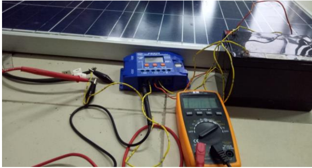
Gambar A. 14. Pengambilan Data V dan I PV
