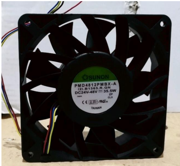
Gambar 4. 10 Beban DC Exhaust Fan 48V
