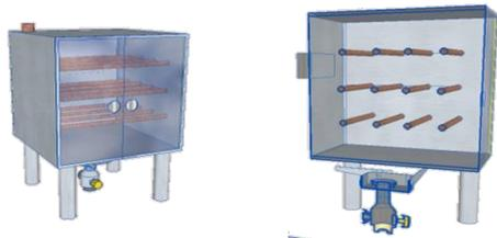
**Gambar 3.3** Geometri alat pengering Hflory
