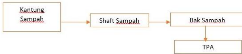
Gambar 4.30 Skema Pembuangan Sampah (Sumber: tropicalarchitectblog.wordpress.com )
