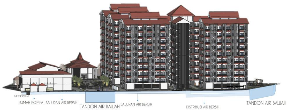
Gambar 5.38 Sistem Sanitasi Air Bersih dalam Site (Sumber: Dok. Pribadi)
