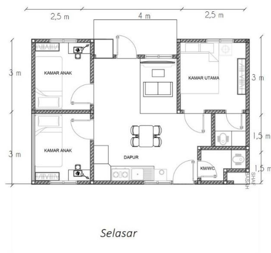
Gambar 5.22 Denah Unit Hunian Tipe 54 Skala 1: 150 (Sumber: Dok. Pribadi)
