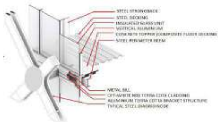
Gambar 5.38 Detail sambungan secondary skin (Sumber: Dokumentasi Pribadi)
