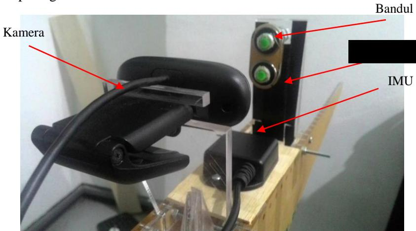
Gambar 4.20 Foto Rangkaian Instrumen.
