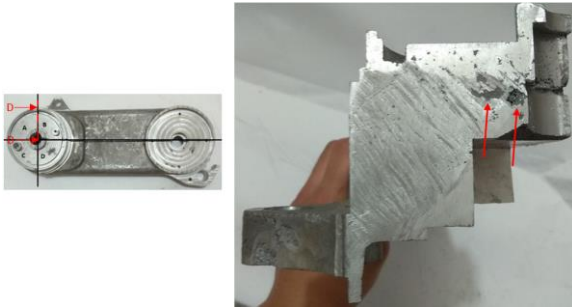
Gambar 4.7 Cacat shrinkage porosity pada base case CVT bagian B potongan D-D
