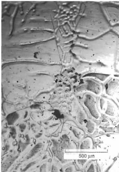
Gambar 2.20 Segregasi pada Al-0,2Cu [20]
