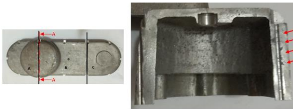
Gambar 4.17 Cacat gas porosity cover CVT bagian A potongan A-A
