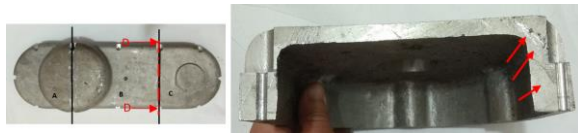
Gambar 4.20 Cacat gas porosity cover CVT bagian C potongan D-D
