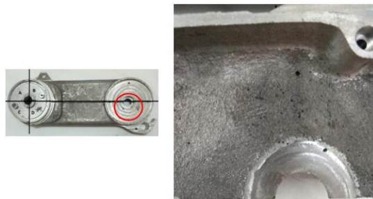
Gambar 4.12 Cacat gas porosity pada permukaan base case CVT potongan D tampak belakang
