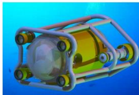
Gambar 2.6 Desain mini ROV untuk survei dan inspeksi
