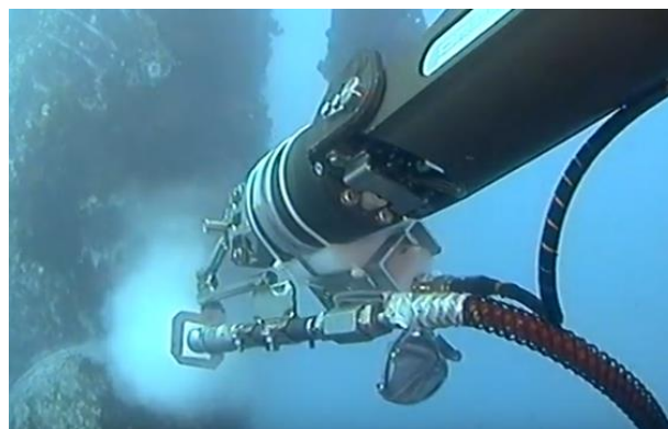
Gambar 1.2 Penggunaan ROV dalam membersihkan pipa
