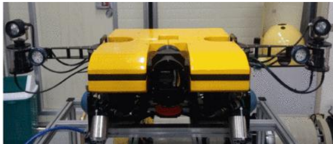
Gambar 2.6 ROV untuk inspeksi bangunan dalam air [12].
