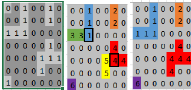
Gambar 2.27 Gambar biner (kiri). Label dari gambar tahap scan pertama (tengah). Label dari gambar tahap scan kedua (kanan)
