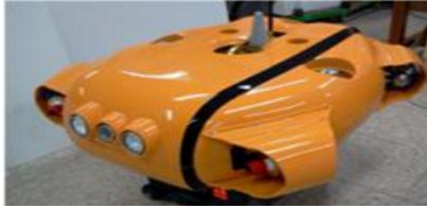
Gambar 2.3 ROV dengan 6 derajat kebebasan [9].
