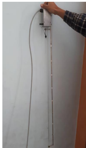
Gambar 3. 10 Wave Probe (dokumen pribadi)
