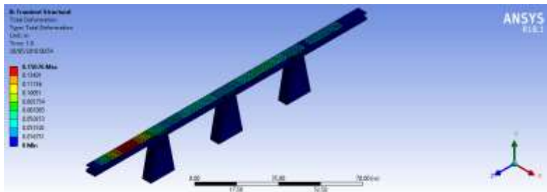
Gambar 3. 9 Lendutan jembatan Lahor
