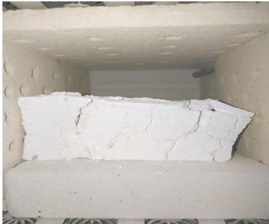
**Gambar 4.2** Tampilan Produk Kalsinasi Setelah Pemanasan  $900^\circ\text{C}$  Selama 5 Jam
