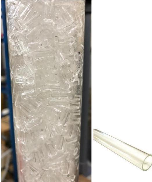
**Gambar III. 2** Raschig Ring pada *Packing* Kolom Absorber
