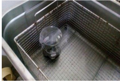
Gambar 3.4 Proses Eksfoliasi Mekanik dengan Ultrasonic Cleaner
