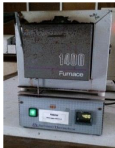
Gambar 3.2 Proses Pemanasan Serbuk Arang Tempurung Kelapa Tua dengan Furnace
