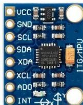
Gambar 4.5 Modul IMU GY-521 yang berbasis MPU 6050
