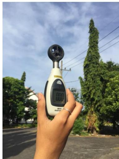
**Gambar 2.** Pengukuran Kecepatan Angin
