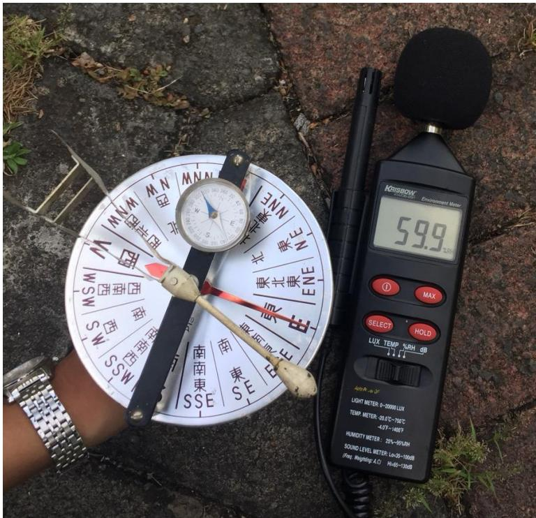
**Gambar 3.** Pengukuran Arah Angin, Kelembapan dan Temperatur
