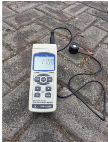
**Gambar 1.** Pengukuran Radiasi Matahari
