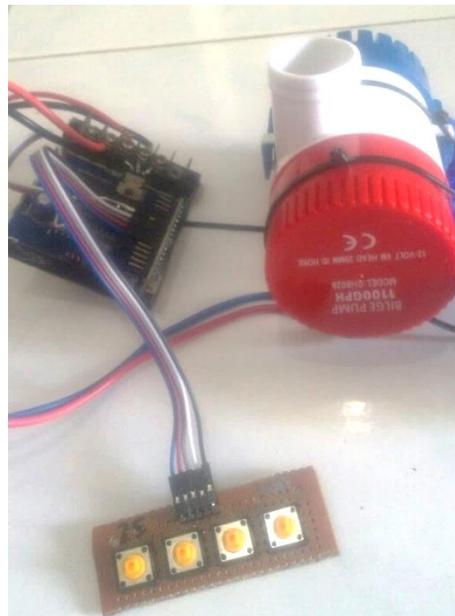
Gambar 4.1 Alat Uji Pembuat Gangguan (*disturbance*)
