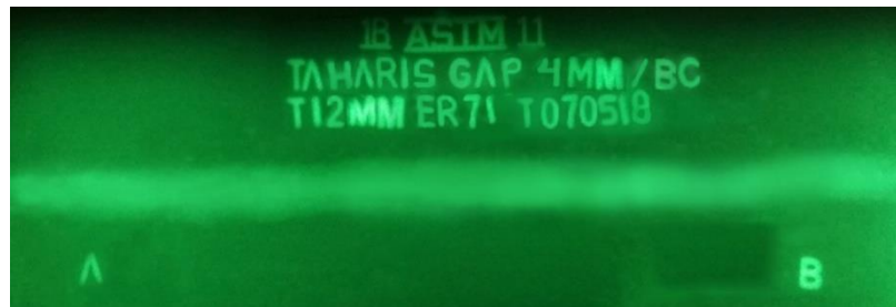
Gambar 4.9. Film Hasil Radiografi Pengelasan FCAW Dengan Gap 4 mm Dengan Backing Ceramic
