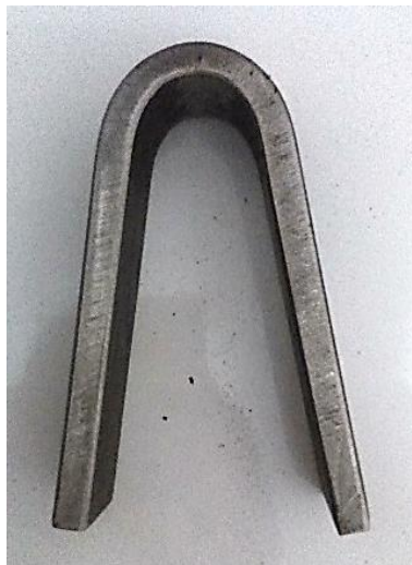
Gambar 4.17. Hasil Uji Root Bend Pengelasan Gap 2 mm Pengelasan Dua Sisi tanpa Backing Ceramic
