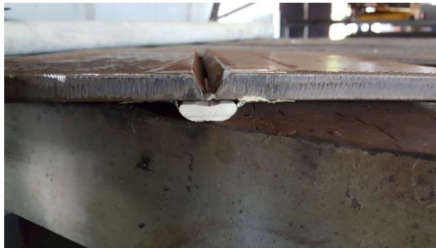
Gambar 4.1. Persiapan Material Pelat Baja AH 36 Dengan Backing Ceramic
