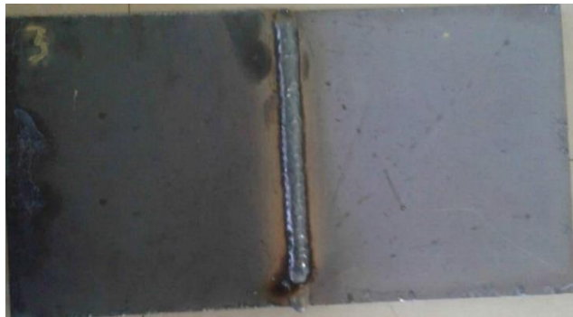
Gambar 4.4. Plat Material Baja AH 36 Dengan Gap 4 Mm Setelah Pengelasan Dengan Backing Ceramic
