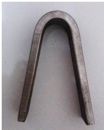
Gambar 4.14. Hasil Uji Root Bend Pengelasan Gap 2 mm dengan Backing Ceramic
