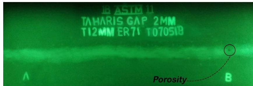
Gambar 4.7. Film Hasil Radiografi Pengelasan FCAW Dengan Gap 2 mm tanpa Backing Ceramic
