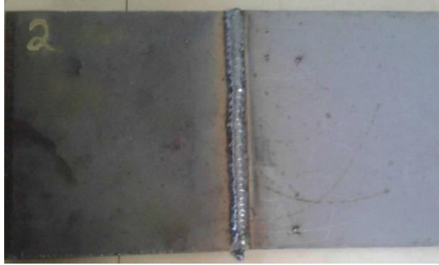
Gambar 4.3. Plat Material Baja AH 36 Dengan Gap 2 Mm Setelah Pengelasan Dengan Backing Ceramic
