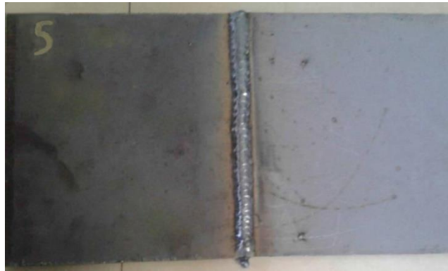
Gambar 4.6. Plat Material Baja AH 36 Setelah Pengelasan Dua sisi tanpa Backing Ceramic
