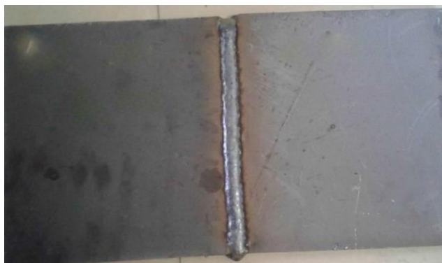
Gambar 4.2. Plat Material Baja AH 36 Dengan Gap 2 mm Setelah Pengelasan Tanpa Backing Ceramic
