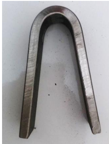
Gambar 4.16. Hasil Uji Root Bend Pengelasan Gap 6 mm dengan Backing Ceramic
