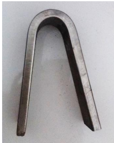
Gambar 4.15. Hasil Uji Root Bend Pengelasan Gap 4 mm dengan Backing Ceramic
