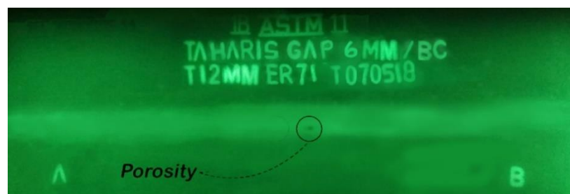
Gambar 4.10. Film Hasil Radiografi Pengelasan FCAW Gap 6 mm dengan Backing Ceramic
