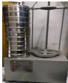
Gambar 3. 1 Satu set saringan agregat
