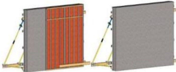
Gambar 8. 20 Pelepasan Panel/Papan Bekisting (Sumber : Slideshare.com “Metode Pelaksanaan Pembongkaran Pekerjaan Bekisting”)
