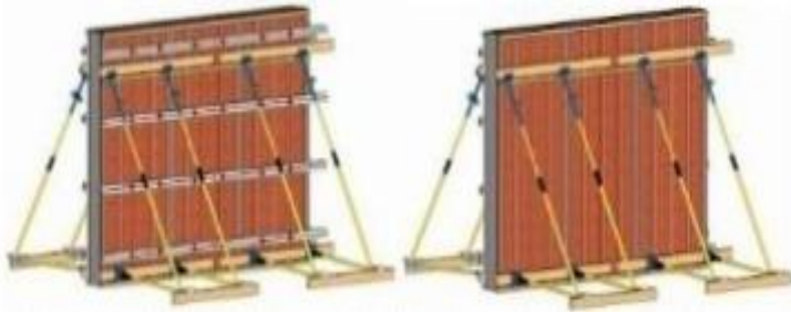
Gambar 8. 18 Pelepasan Balok Perangkai pada Bekisting (Sumber : Slideshare.com “Metode Pelaksanaan Pembongkaran Pekerjaan Bekisting”)
