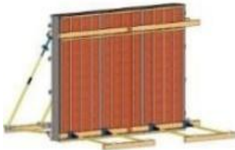
Gambar 8. 19 Pelepasan Push Pull Penyangga Bekisting (Sumber : Slideshare.com “Metode Pelaksanaan Pembongkaran Pekerjaan Bekisting”)
