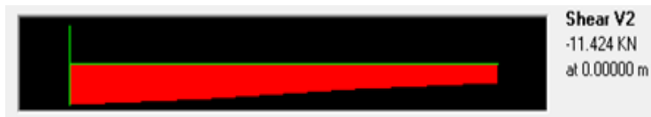
Gambar 7. 20 Diagram Geser Balok Kantilever
