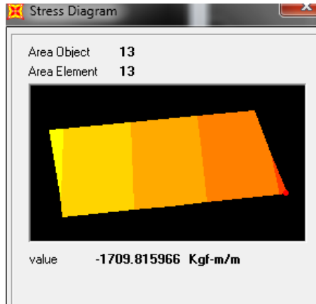
Gambar 7. 9 Diagram Momen Pelat Bordes Hasil Analisa SAP2000
