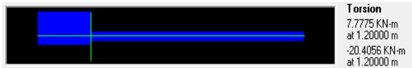
Gambar 6. 21 Diagram Torsi Balok Induk
