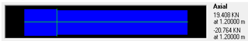
Gambar 6. 22 Diagram Gaya Aksial Balok Induk
