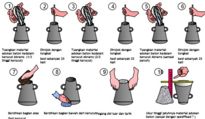
Gambar 8. 12 Tahapan Slump Test Beton (Sumber : Metode Pelaksanaan PT. PP)
