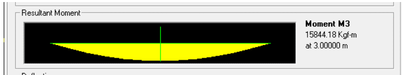
Gambar 6.28 Hasil Momen Maksimum pada Balok Anak
