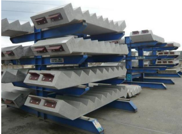
Gambar 2.9 Tangga Pracetak dengan Anak Tangga dan Bordes Terpisah
