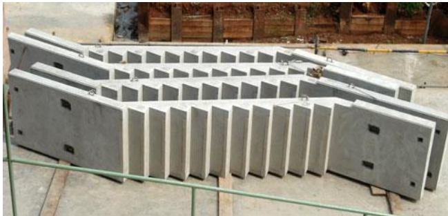
Gambar 2.10 Tangga Pracetak dengan Anak Tangga dan Bordes Menyatu
