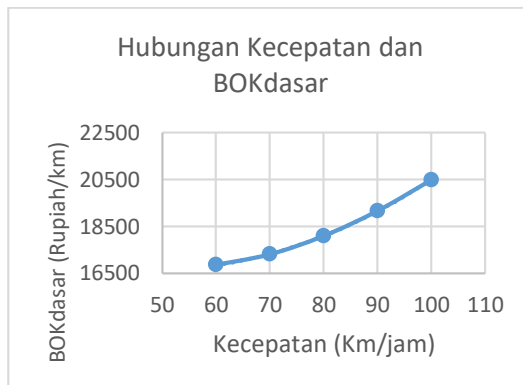
Gambar 2. 9 Hubungan Kecepatan dan BOKdasar Kendaraan Golongan V
