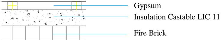
Gambar 3.4. Skema Lapisan Dinding Atas
