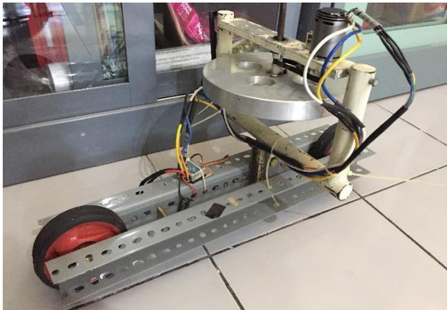
**Gambar 4.7.** Hasil pembuatan *self balancing bike*
