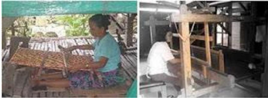
**Gambar 2.35** ATBM yang digunakan dengan duduk dilantai (kiri); ATBM yang digunakan dengan duduk di bangku (kanan)
