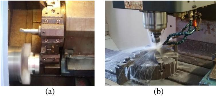
Gambar 5.14 (a) Proses Pengerjaan Komponen dengan CNC *Turning* (b) Proses Pengerjaan Komponen dengan CNC *Milling*
