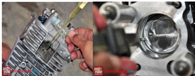
Gambar 2.11 Metode Pengukuran Rasio Kompresi
